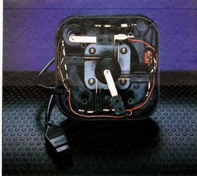
Bild 2. Geöffneter Joystick mit Federkontakten
